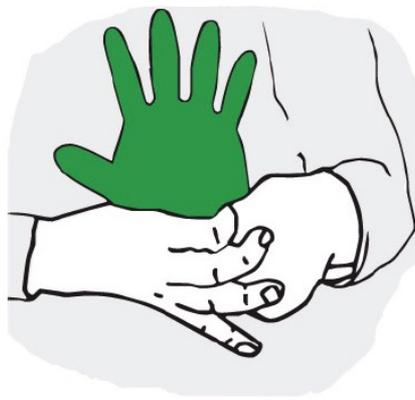
Figura 4. Comprobación de la ausencia de fugas.
