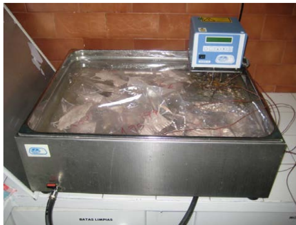
Foto 9. Equipo para la medida de las pérdidas por cocinado de la carne.
