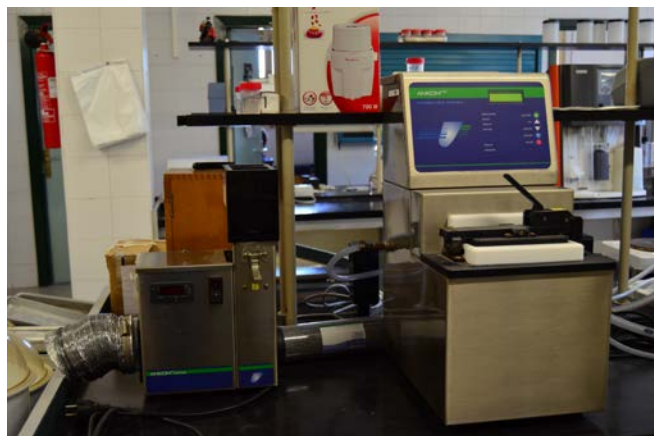
Foto 6. Equipo para el análisis de extracto etéreo.
