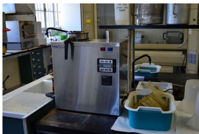
Foto 7. Equipo para el análisis de fibra.
