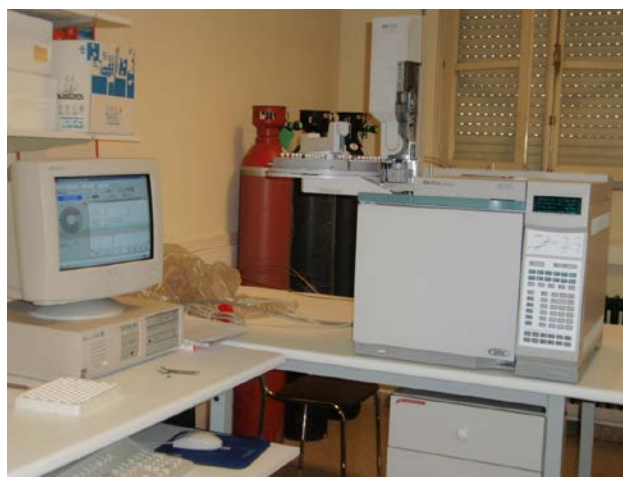
Foto 11. Equipo para el análisis del perfil de ácidos grasos.
