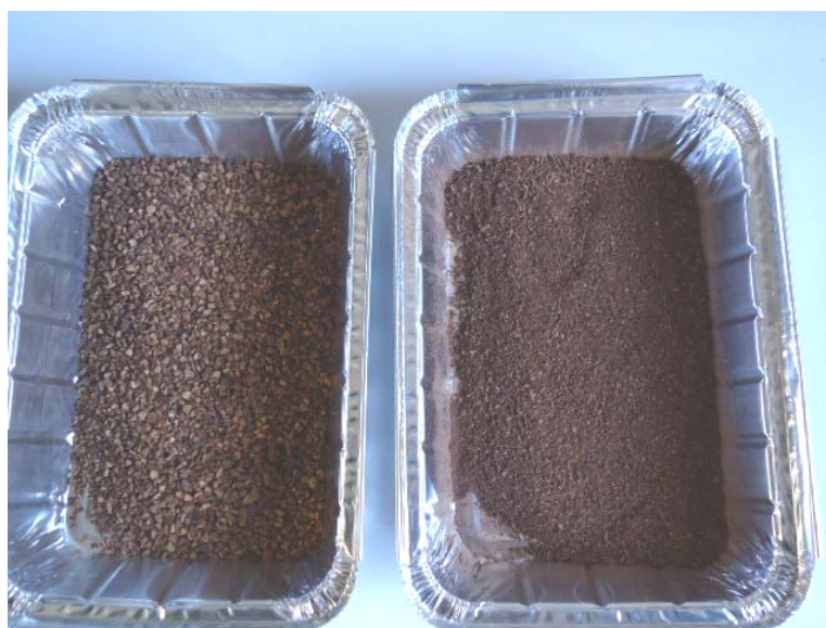
Foto 2. Muestras de alperujo parcialmente desecado antes (izq.) y después (der.) de ser tamizado.
